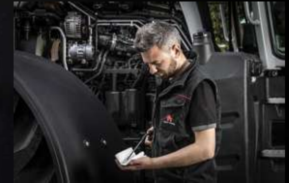
El eje delantero y el diseño de capó estrecho facilitan el acceso a la varilla de medición del aceite y al filtro.
